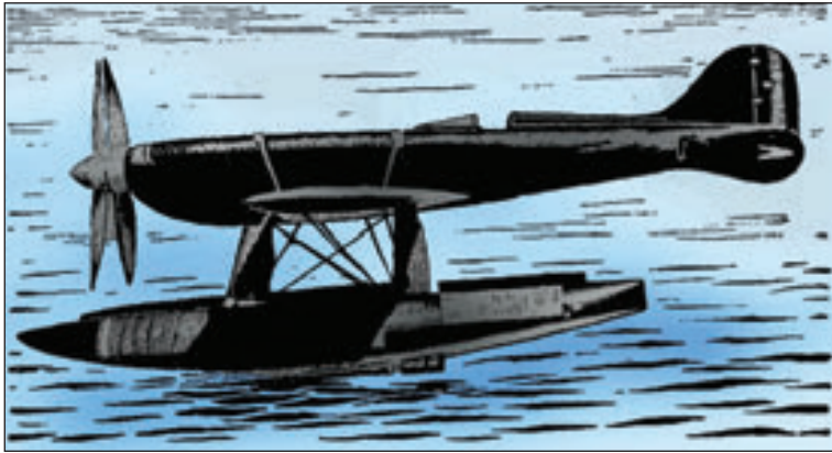
Рис. 3. Гідроплан «Маккі-Кастальді», на якому італійський льотчик Ф. Аджело у 1934 р. встановив світовий рекорд зі швидкості польоту — 709,2 км за год.
