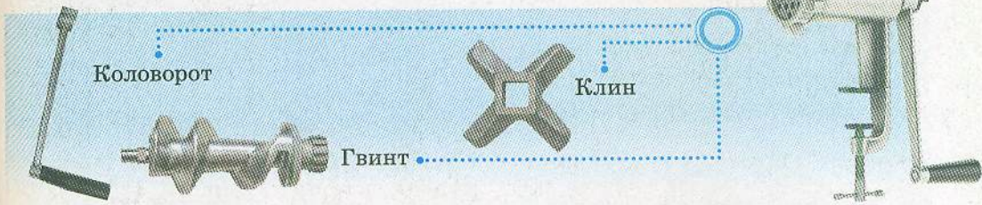
Рис. 1.2. Складний механізм м'ясорубки містить декілька простих механізмів
