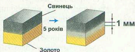
Мал. 3. Дослід зі спостереження дифузії у твердих тілах
