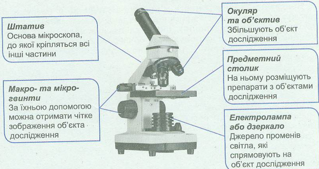
Мал. 4.3. Будова мікроскопа та призначення його складових частин
