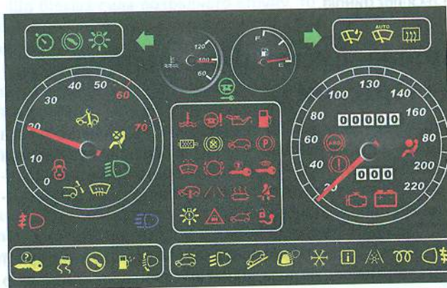
Рис. 1.21. Щиток контрольно-вимірювальних приладів та варіанти піктограм
