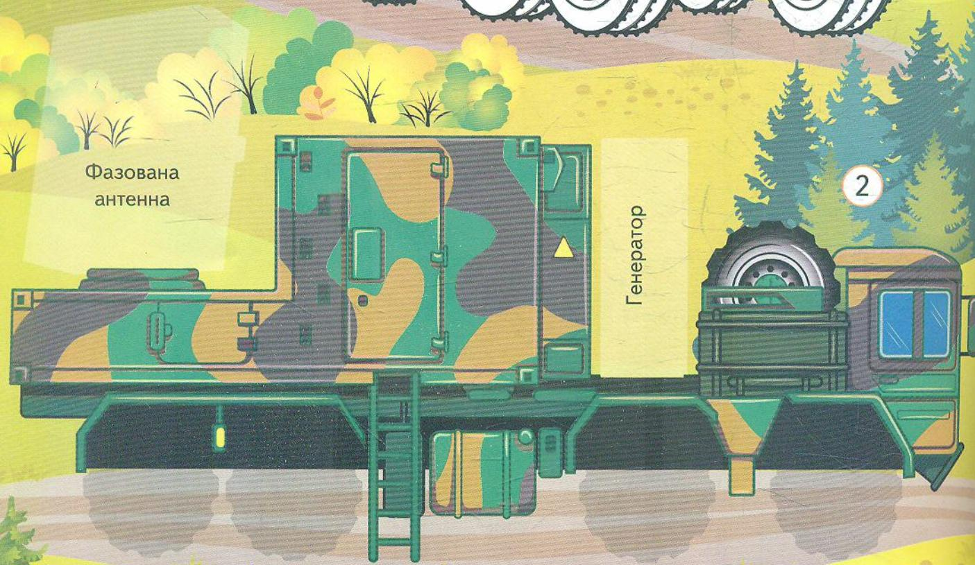
Радар «Кобра» визначає позиції ворожої артилерії на великій відстані. Це дозволяє коригувати вогонь своєї техніки й попереджати українські війська про можливість обстрілу. Доклей фазовану антенну, генератор живлення та колеса (зауваж запасне колесо, розташоване за кабіною). Знайди й покажи на картинці лопату, дві драбини і дві круглі антени.
